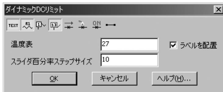
図10-1 ダイナミックDCの解析リミットダイアログボックス
