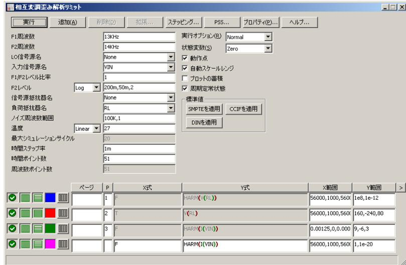
図13-6 相互変調歪み解析リミットダイアログボックス
