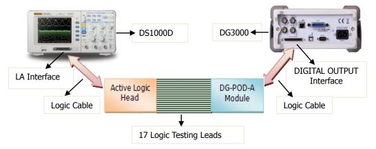
Figure 3-11 DS1000D LA interface connection
