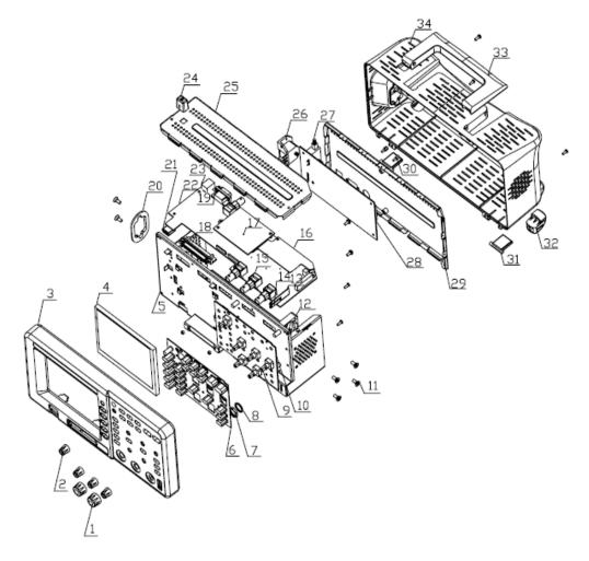
Figure 7-1 DS1000E, DS1000D Exploded View
